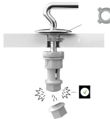
Ako je wc sjedalo ispravno montirano, bez problema podnosi test bočnog povlačenja u stranu od 30 kg (DIN 19516 standard).
