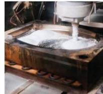
Duroplast, kojeg koristimo u proizvodnji wc sjedala, vrlo je izdržljiv i dugotrajan materijal otporan na ogrebotine, toplinu i svjetlost.
